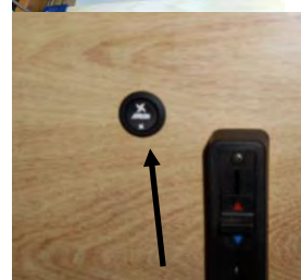
Interrupteur à bascule du booster
