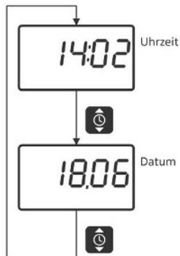
Die Mess- und Anzeigewerte der Uhr- und Thermometer-Funktionen werden mit der Taste 2 (Mitte) weitergeblättert.
