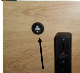
Zur zusätzlichen Warmluftversorgung des Armaturenbrettes kann optional ein Heiz-Booster dem Heizkreislauf angeschlossen werden. Über den Schalter am Beifahrerstaukasten lassen sich zwei Gebläsestufen anwählen, bzw. der Booster abschalten.
