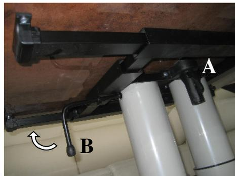
Vor Fahrtbeginn muss die Tischplatte arretiert werden, so dass ein Verschieben in Kurven oder bei einer Vollbremsung vermieden wird.
