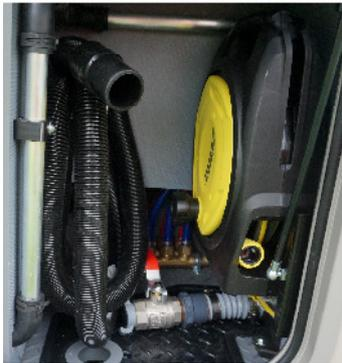
Bei Integrierten Reisemobilen auf Mercedes sind die Frischwasser Schlauchtrommel, der Wasserverteiler und der Abwasser Entsorgungsschlauch im Zentralversorgungsfach untergebracht. In dem herausziehbaren Staufach darüber finden z.B. Adapter und Werkzeuge Platz.
