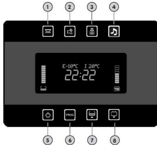
Das Blinken der Anzeige
