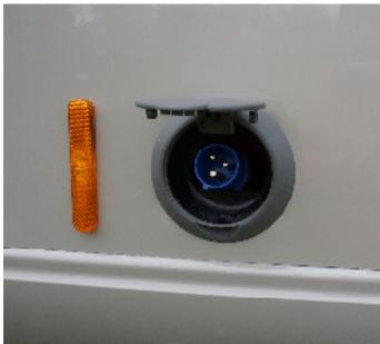
Unter einer separaten Klappe vor dem Zentralversorgungsfach befindet sich die Kabeltrommel mit Aufrollautomatik. Ziehen Sie das Stromkabel heraus. Nach erneutem leichten Ziehen am Kabel rollt es sich selbständig wieder auf.
