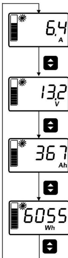
Die Mess- und Anzeigewerte der Solaranlage werden mit der Taste 1 (Links) weitergeblättert.
