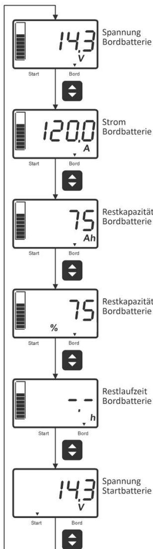
Die Mess- und Anzeigewerte der Batterie-Computer Funktionen werden mit der Taste 1 (links) weitergeblättert.
