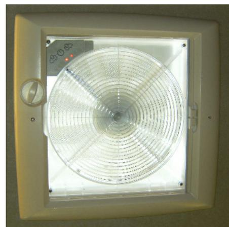
Die „Fiamma“-Dachluken mit Ventilator werden ebenso durch Betätigen des Drehgriffes geöffnet. Der Kippschalter steuert die Drehrichtung des Ventilators.
