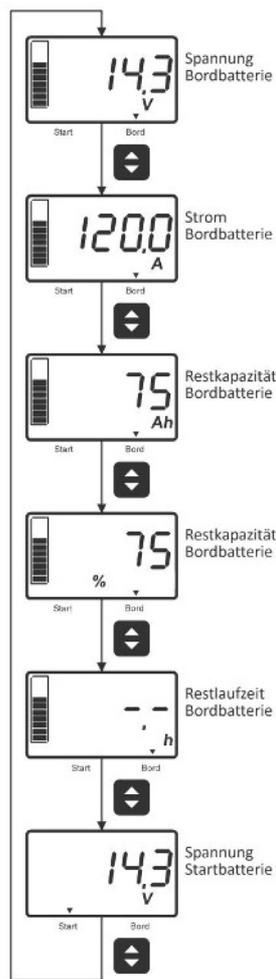
Die Mess- und Anzeigewerte der Batterie-Computer Funktionen werden mit der Taste 1 (links) weitergeblättert.
