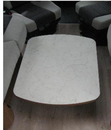
Bei Grundrissen mit Rundsitzgruppe muss zunächst der Tisch abgesenkt werden und ausziehbare Aluminiumprofile in die Aufnahmen eingehängt werden, um eine durchgehende Liegefläche, bzw. Notbett zu erhalten.
