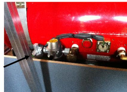
Ist der Gastank zusätzlich zum Gaskasten mit Gasflaschen verbaut, wählen Sie am 3-Wege-Ventil die Gasquelle aus. Das 3-Wege-Ventil ist nahe dem Gas-Verteiler montiert.
