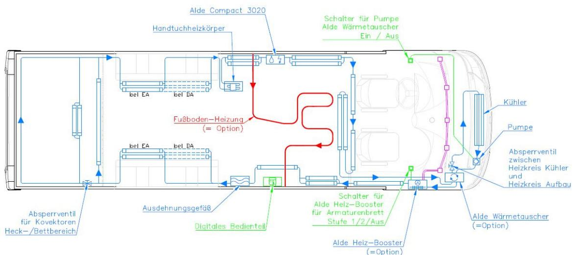
Schema Warmwasserheizung Integriert
