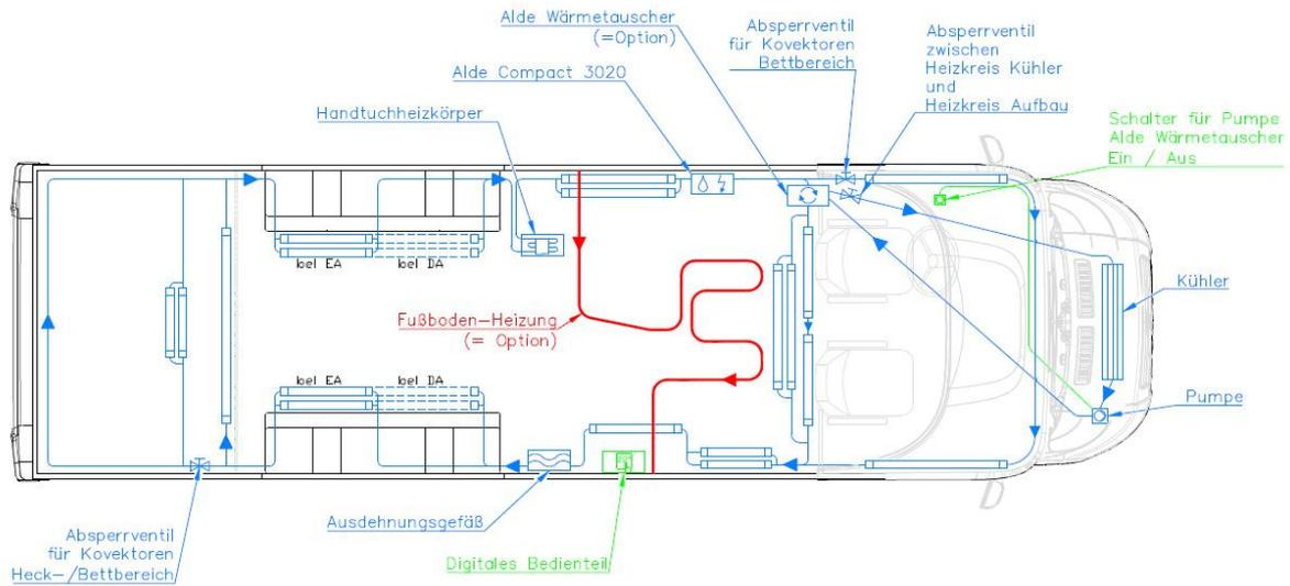
Schema Warmwasserheizung Alkoven
